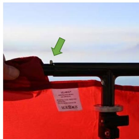
Ziehen Sie nun die erste Querstange wieder heraus, bis der Druckknopf wieder sichtbar ist und von selbst herauspringt.
